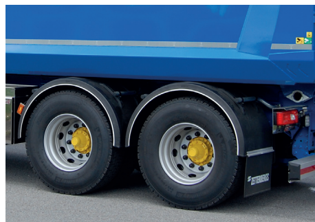
Stänkskärmar runda i plast, monterade i chassiram.
