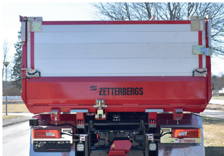
Automatläm standard höjd 400 mm. Pneumatisk eller hydraulisk.
