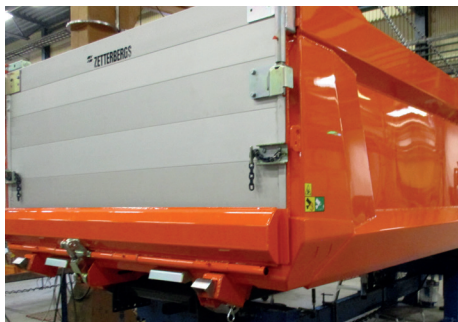
Automatläm standard höjd 250 mm. Pneumatisk eller hydraulisk.
