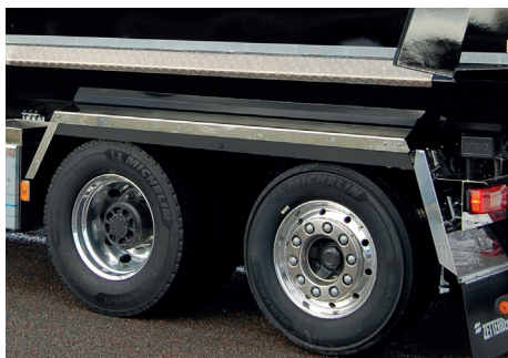
Stänkskärmar raka i rostfritt stål, monterade i dumperkorg.
