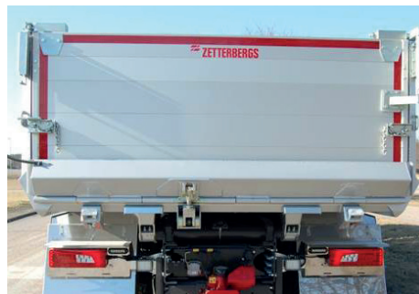
Automatläm HD höjd 250 mm. Hydraulisk.
